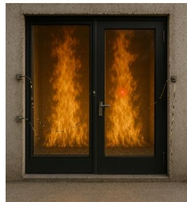
Zusammenfassend bieten Laser Distanzsensoren in Feuerwiderstandsprüfungen eine zuverlässige, berührungslose Lösung, die genaue und schnelle Messungen von Durchbiegungen ermöglicht. Diese Fähigkeit ist entscheidend, um die Feuerbeständigkeit verschiedener Bauelemente zu überprüfen und so zur Verbesserung der Sicherheit und zur höheren Widerstandsfähigkeit von Gebäuden unter extremen Bedingungen beizutragen.
