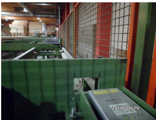
Abb 1: Dimetix Laser misst stirnseitig auf die angeschnittene Holzfläche
