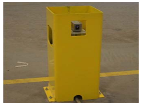
图 2: 系统中嵌入 Dimetix 激光测距传感器
