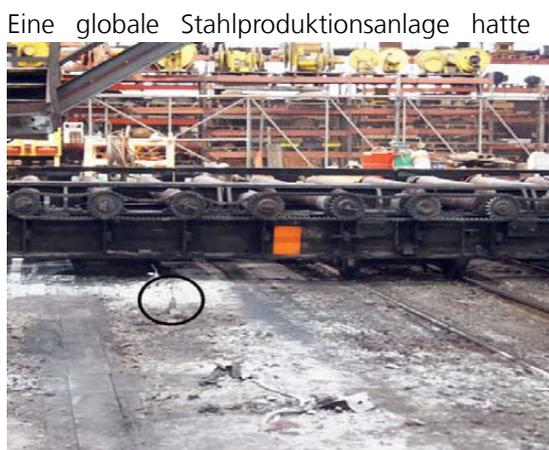
Abb 1: Zieltafel für Sensor am Transportwagen montiert
